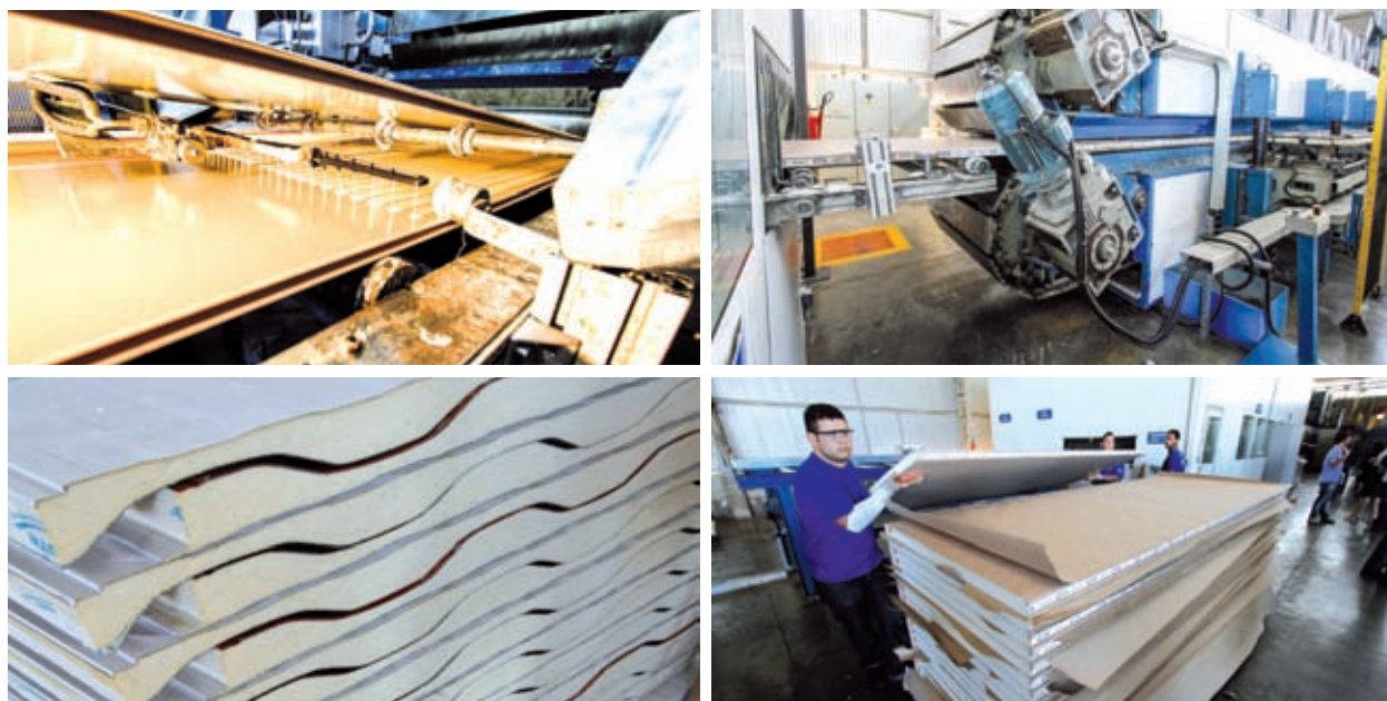
Produção de painéis contínuos utilizando hidrocarboneto em substituição ao HCFC-141b
