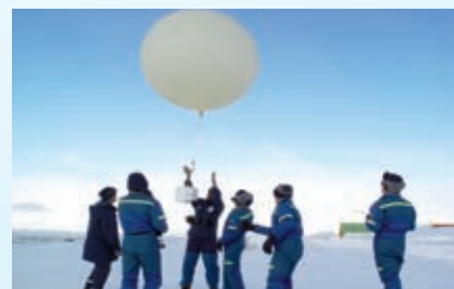
Sistema de rastreamento por sondas de ozônio lançadas em balão
