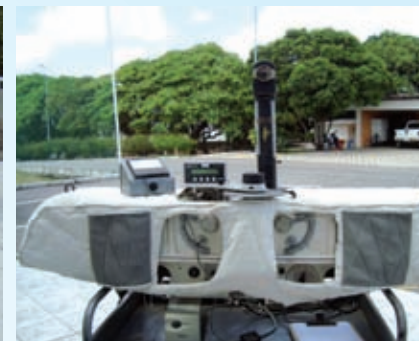
Instrumentos de solo para monitoramento da camada de ozônio. À esquerda Espectrofotômetro Brewer; acima Espectrofotômetro Dobson
